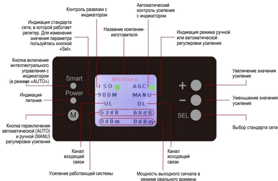
Репитеры с жидкокристаллическим дисплеем оснащены разнообразными интеллектуальными функциями, такими, как контроль развязки антенн, индикация уровня входного и выходного сигнала, индикация стандарта сети, в которой работает репитер, ручная и автоматическая регулировка усиления.
