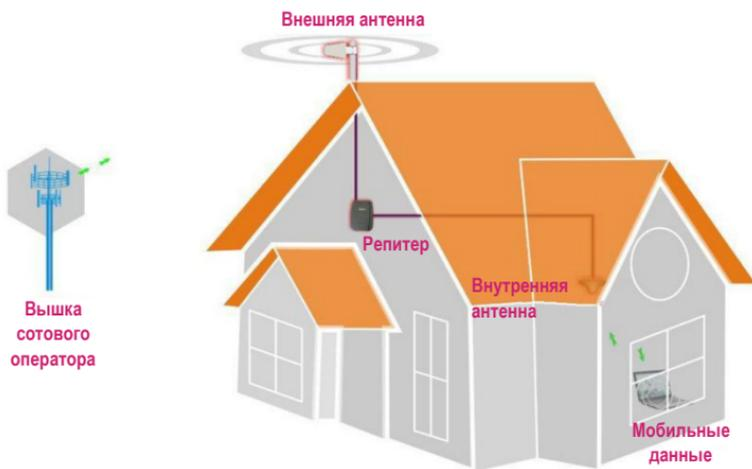
Рисунок 1. Применение усилителя сигнала
