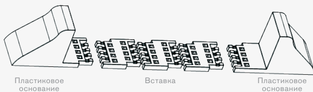
Рис. 3-1-2 Подставка для ИБП совместно с батарейным кабинетом
