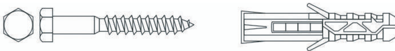
Рисунок 7.4.1 – Шуруп с шестигранной головкой «Глухарь» с дюбелем.
