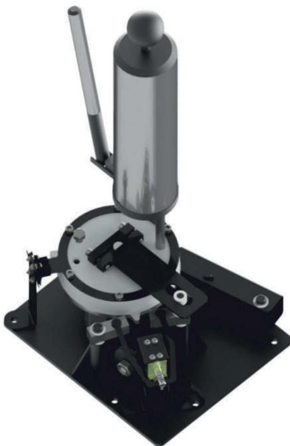
Рисунок 12.3.3 – Доливка демпферной жидкости.
